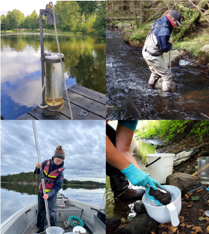
Figur 3. Några provtagningsmoment som utförs inom Nissans recipientkontrollprogram. Ö.v: Vattenkemiprovtagning. Ö.h: Bottenfaunaprovtagning i rinnande vatten. N.v: Provtagning av växtplankton. N.h: Provtagning av kiselalger. © Sweco Sverige AB
